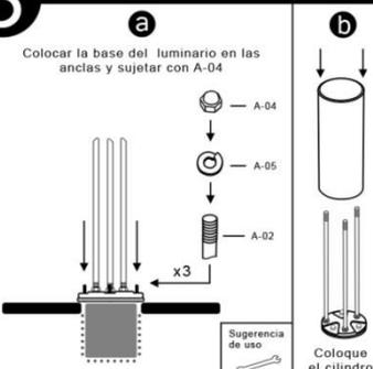
Colocar la base del luminario en las anclas y sujetar con A-04
