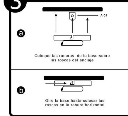
Coloque las ranuras de la base sobre las roscas del anclaje
