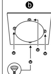
Sujete el cristal para que no se caiga y atornille los soportes para fijarlo
