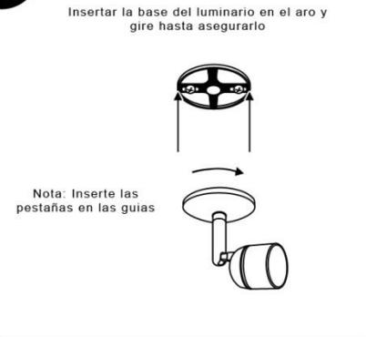
Insertar la base del luminario en el aro y gire hasta asegurarlo
